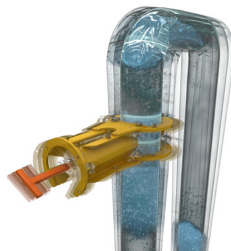
Vibración inducida por flujo sobre pieza de bobina.
